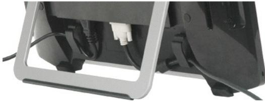
Nach dem Anschließen aller erforderlichen Kabel an Monitor und Computer (siehe [Anschließen des Monitors](#)) können Sie alle Kabel mit Hilfe des Kabelhalters wie oben gezeigt anordnen.
